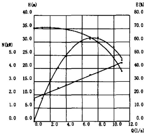
图 1 拟合的某离心泵性能曲线图
