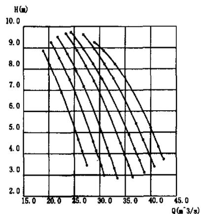
图 2 拟合的某轴流泵  $H \sim Q$  性能曲线图
