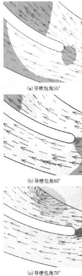
图 6 导壁包角 55°,65°,70°的流线对比图
