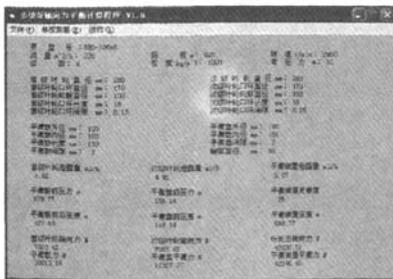
图 5 海水淡化高压多级泵轴向力平衡计算结果
