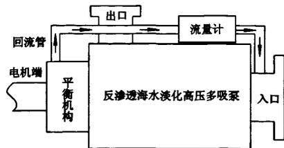
图 7 泄漏量试验原理图
