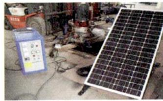
图6 光伏泵系统试验台
