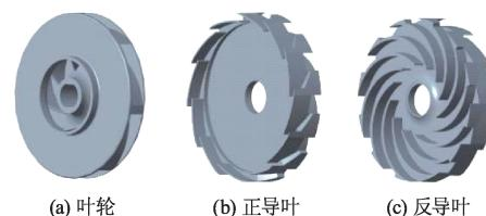
图1 模型泵叶轮和导叶结构
