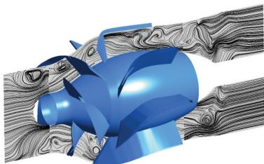
图4 0.75 $Q_d$  工况下子午面流线图
