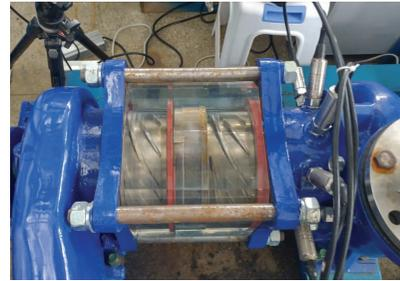
图 1 3 级叶片式气液混输泵
