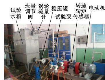
(a) 离心泵闭式试验台
