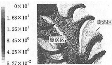
图 5 叶片中径速度图
